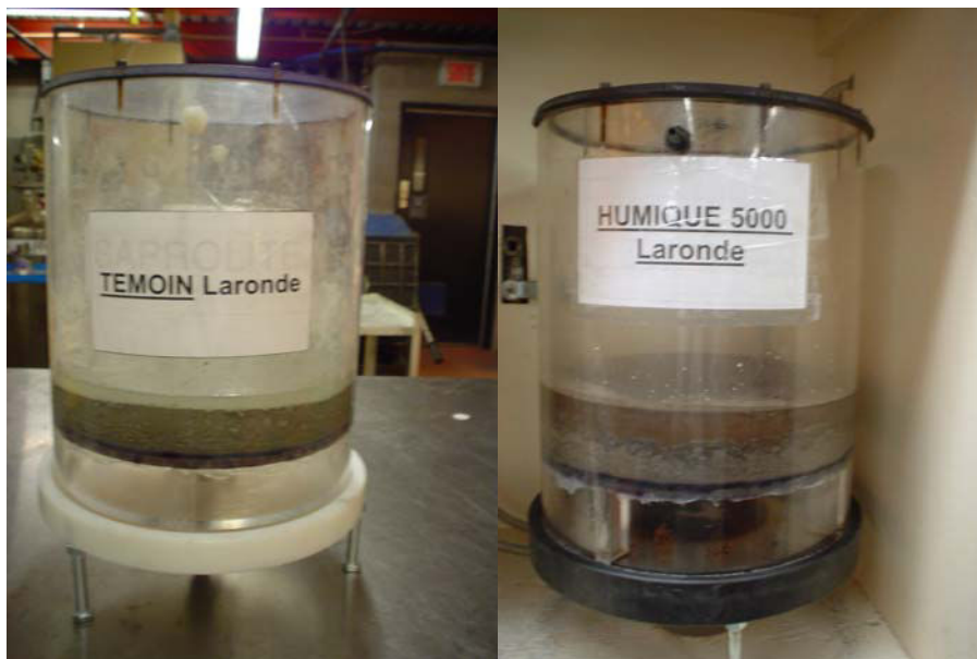
Figure 53: Montage des cellules d'humidité avec le stérile LaRonde (2005).
