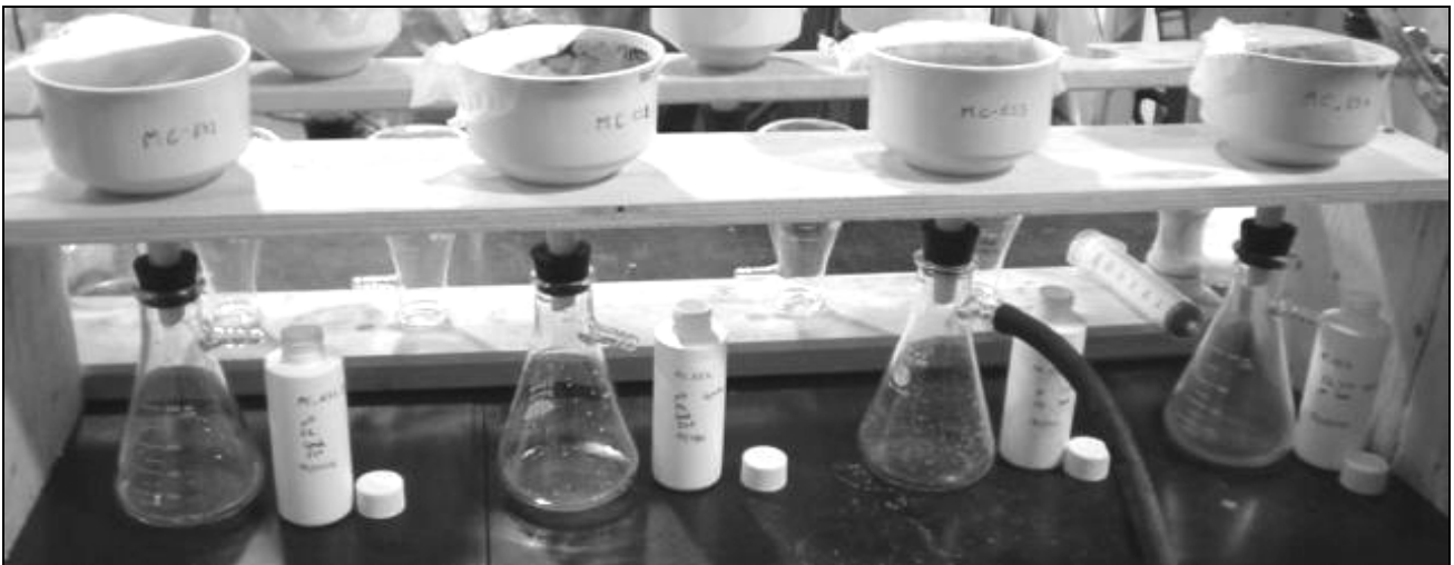
Figure 52: Montage de mini cellules d'altération.
