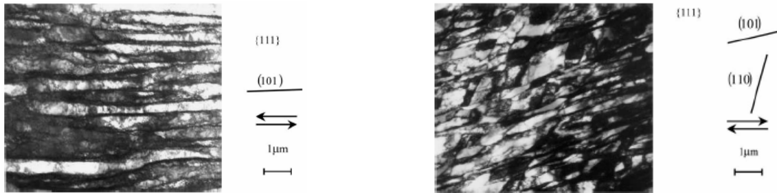
Figure I.2. Structures en cellules de dislocations observées sur un acier doux sollicité en cisaillement a) déformation de 0.26 b) déformation de 1 [VRGB05]
