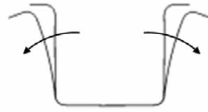
Figure I.8. Effet du retour élastique sur une structure crash-box réalisée par emboutissage
