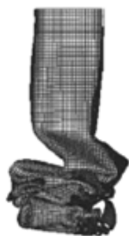
Figure I.36. Simulation de l'écrasement d'une structure en acier TRIP [TBG06] a) avec prise en compte de l'étape de fabrication b) sans prise en compte de l'étape de fabrication
