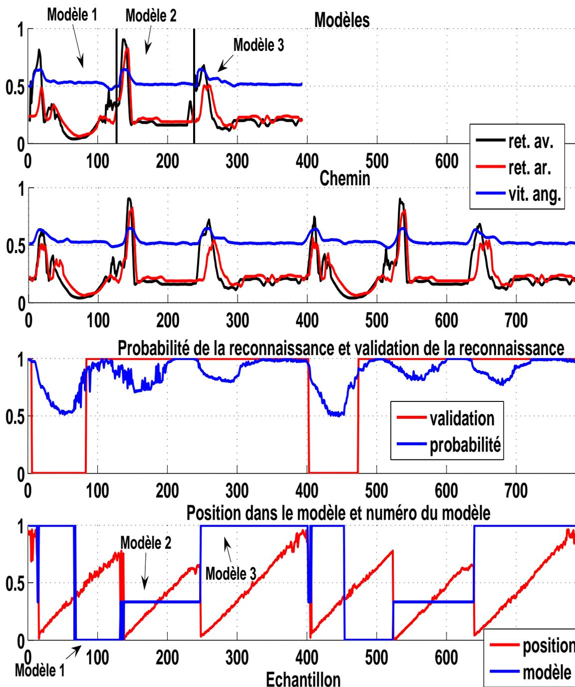
FIG. 6.12: Résultats des tests réels avec une commande du fauteuil par le joystick. Cette figure présente les 3 modèles, les trajets parcourus. Les résultats montrent que la reconnaissance est validée lorsque le fauteuil suit le même trajet que les modèles (avec enchaînement).
