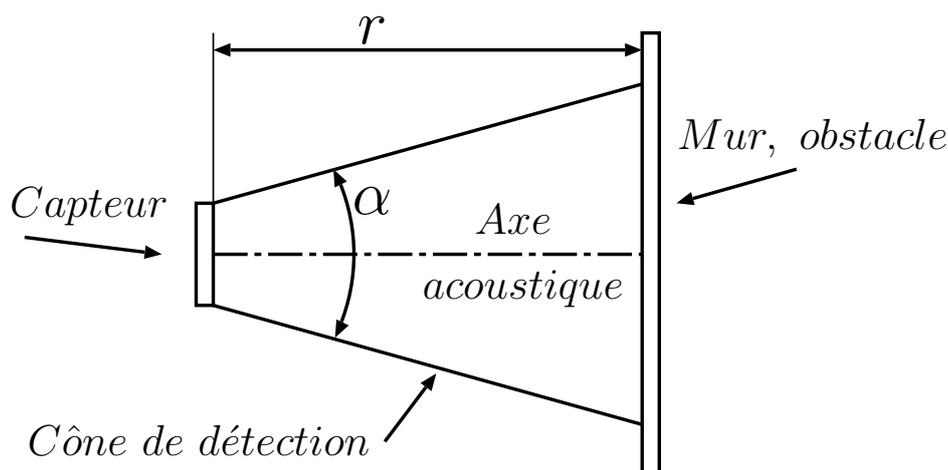
FIG. 2.7: Schéma de fonctionnement d'un capteur US.
