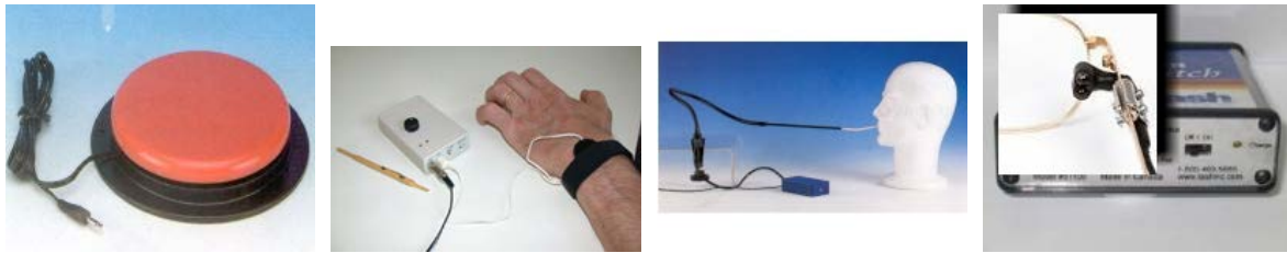
(a) Exemple de capteur de grand taille ne demandant pas une grande précision pour être actionné. (b) Exemple de capteur musculaire. Ce capteur réagit aux contractions, même faibles, d'un muscle. (c) Exemple de capteur de souffle. (d) Exemple de capteur de paupière monté sur lunettes. Ce capteur réagit au passage de la paupière dans le faisceau IR normalement réfléchi par l'oeil.
