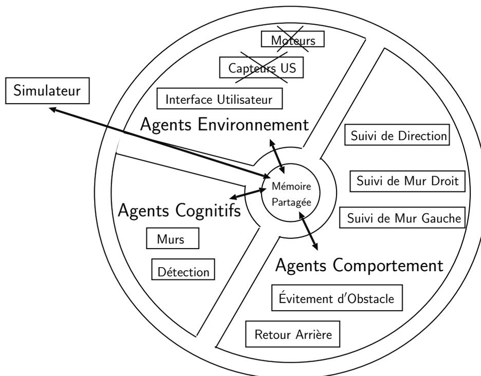
FIG. 3.7: La structure multi-agent avec le simulateur.
