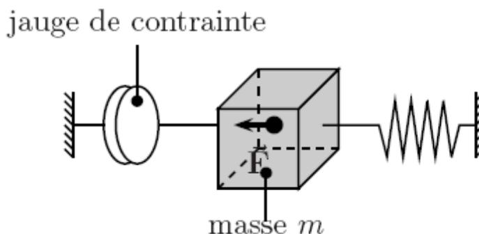
FIG. 2.4: Exemple de fonctionnement d'un accéléromètre. Lors de l'accélération, le mobile de masse  $m$  produit une force  $\vec{F}$  qui est mesurée par la jauge de contrainte. L'accélération  $\gamma$  est donnée par la formule  $\gamma = F/m$ .
