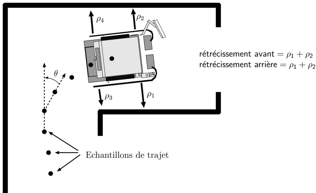
FIG. 5.8: Vecteurs d'observations choisis pour tester l'algorithme CONDENSATION.
