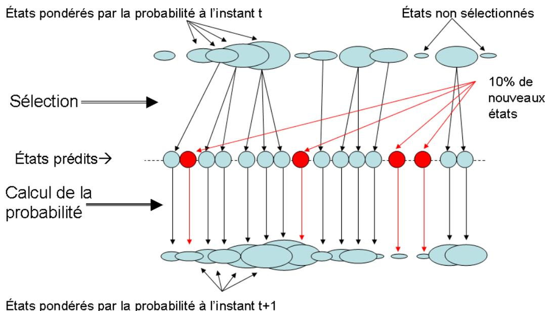
FIG. 5.4: Fonctionnement de l'algorithme CONDENSATION.
