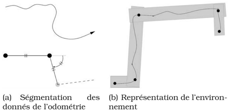
FIG. 2.25: Segmentation des données odométriques utilisées sur le fauteuil intelligent "Rolland" [49]. Les données retenues sont la longueur du segment et son angle avec le segment précédent.
