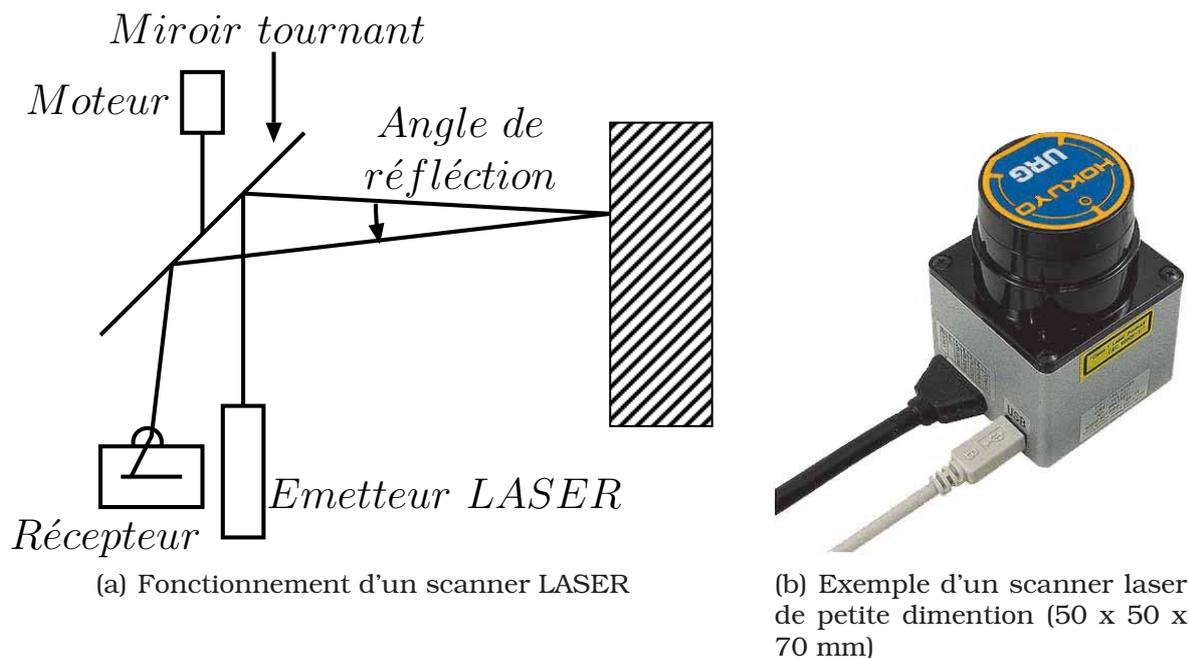
FIG. 2.9: Fonctionnement d'un scanner LASER
