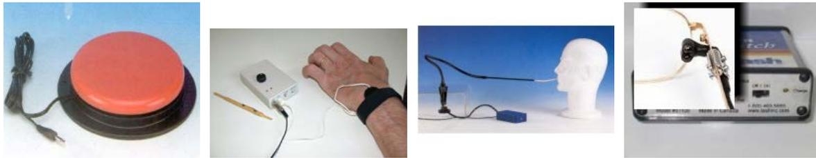
(a) Exemple de capteur de grand taille ne demandant pas une grande précision pour être actionné. (b) Exemple de capteur musculaire. Ce capteur réagit aux contractions, même faibles, d'un muscle. (c) Exemple de capteur de souffle. (d) Exemple de capteur de paupière monté sur lunettes. Ce capteur réagit au passage de la paupière dans le faisceau IR normalement réfléchi par l'oeil.
