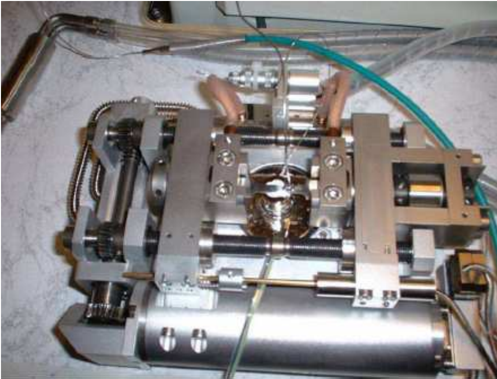
Figure III. 14 : Machine de traction permettant de réaliser des essais in-situ
