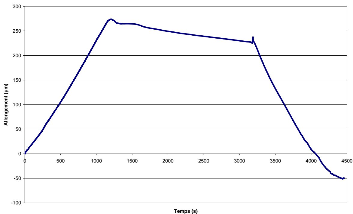
Figure A2.4: Résultats de l'essai de dilatométrie à 1°C/s, allongement en fonction du temps
