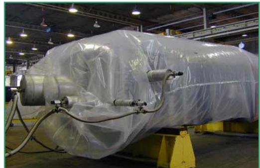
**Figure I.22 - Test hélium**
