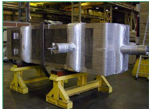
Figure I.20 - Échangeur muni de ses têtes
