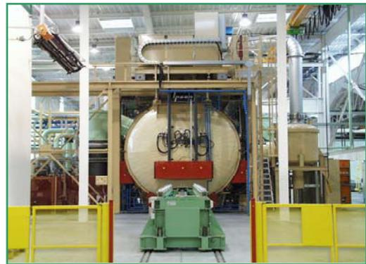
Figure I.18 - Four utilisé pour le brasage
