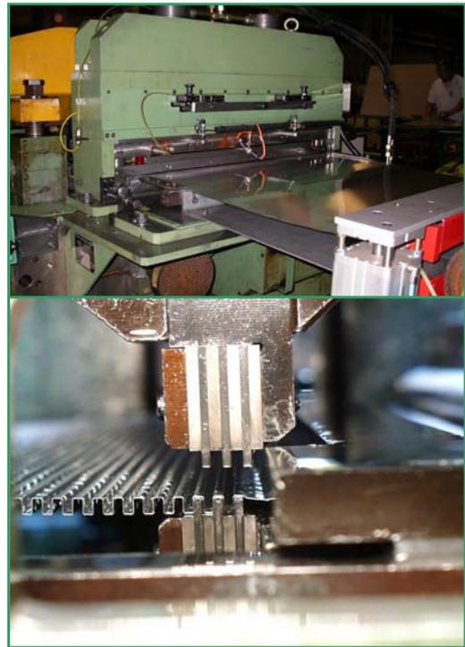
Figure I.16 - Fabrication des ondes
