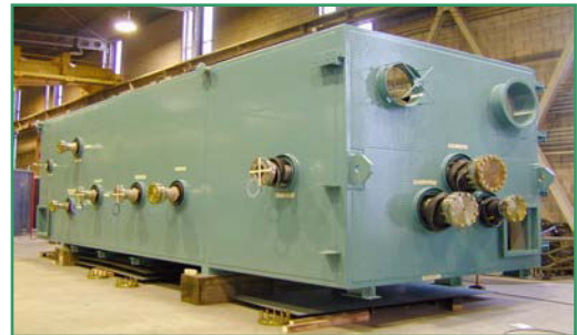
Figure I.24 - Boîte froide vue extérieure
