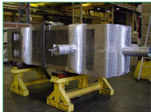
Figure I.20 - Échangeur muni de ses têtes
