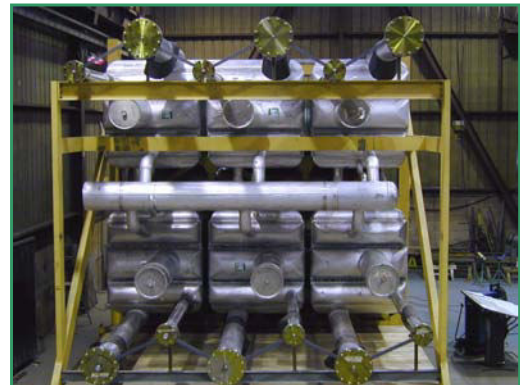
Figure I.25 - Échangeurs en batterie
