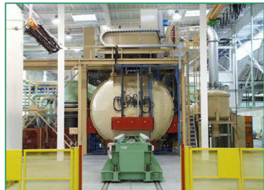
Figure I.18 - Four utilisé pour le brasage
