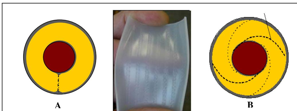
**Figure I. 14.** *Lignes de soudure [SCH00]*
