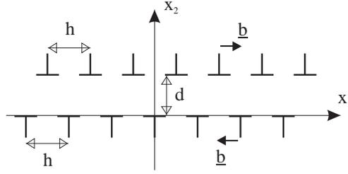
Figure X.3: Edge dipolar mat.
