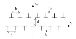
Figure X.3: Edge dipolar mat.
