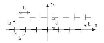
Figure X.9: Edge dipolar wall.
