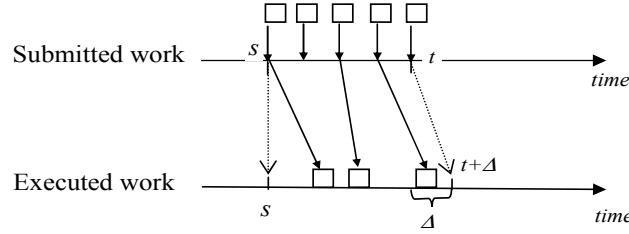
**Fig. 35: R-(3,5)-firm constraint**
