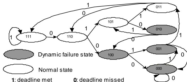
**Figure 2 : diagramme de transition d'Etat avec (2.3)-firm**
