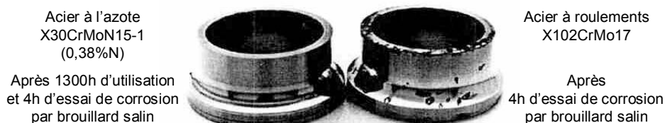
Figure 1-6. Bagues de roulement après essai de corrosion par brouillard salin [STE03].
