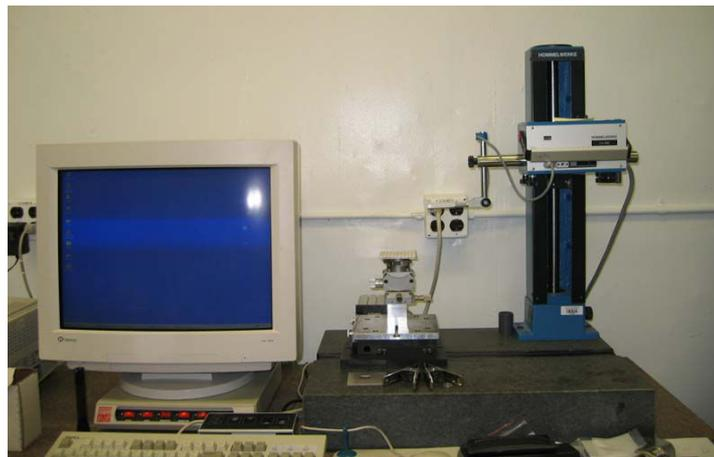
Figure III-13 : Profilomètre Hommel Surface Roughness Profilometer (LV-50).
