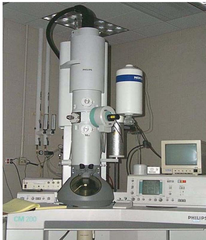
Figure III-11: Microscope Electronique à Transmission TEM Philips CM200.
