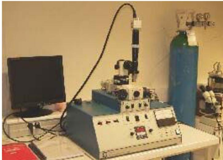
Figure III-12 : Amincisseur ionique PIPS (Precision Ion Polishing System) GATAN.
