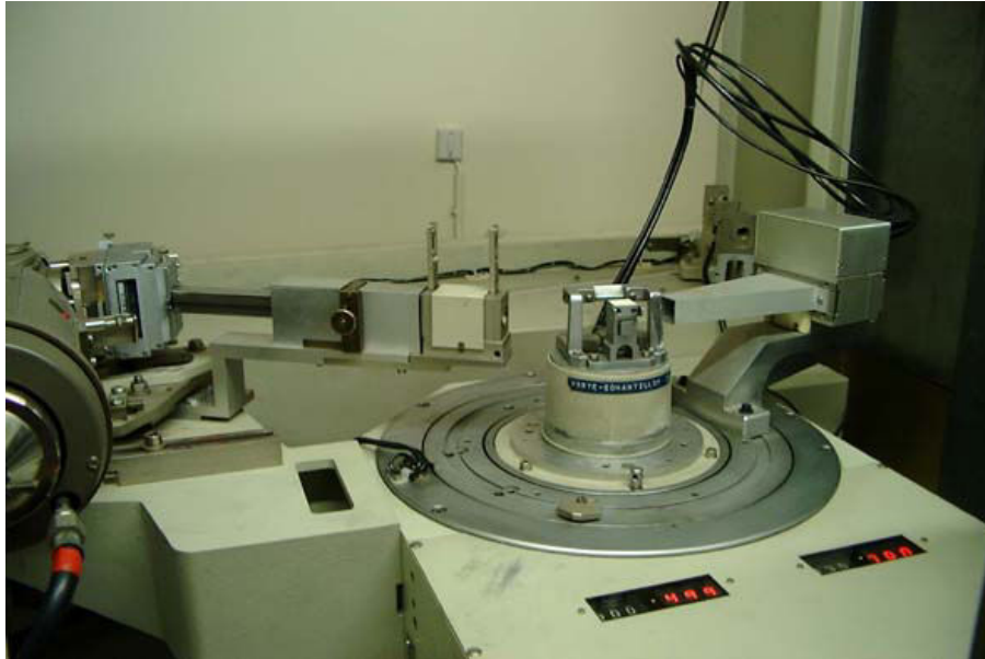
Figure III-6 : Diffractomètre SIEMENS d500 du LSG2M, utilisé dans cette étude.
