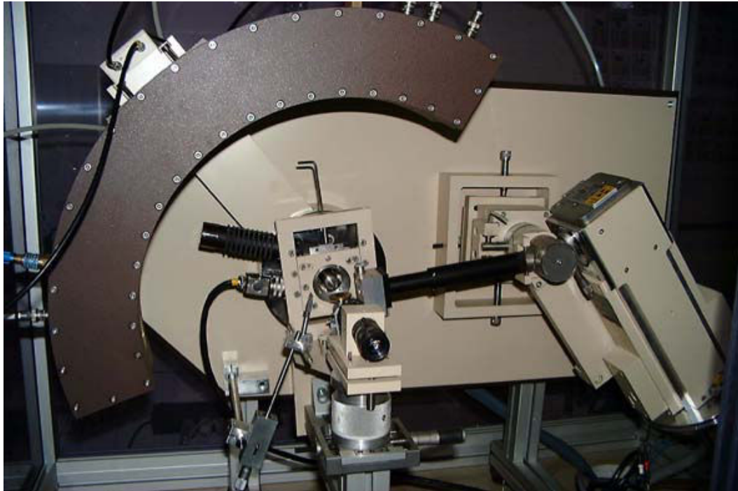
Figure III-7 : Diffractomètre INEL à incidence fixe, compteur courbe CPS 120.
