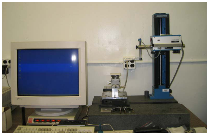
Figure III-13 : Profilomètre Hommel Surface Roughness Profilometer (LV-50).
