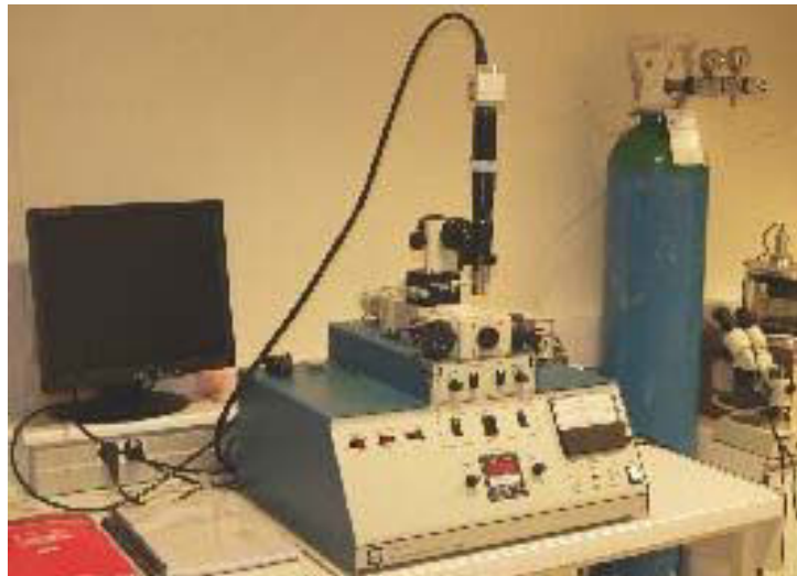
Figure III-12 : Amincisseur ionique PIPS (Precision Ion Polishing System) GATAN.
