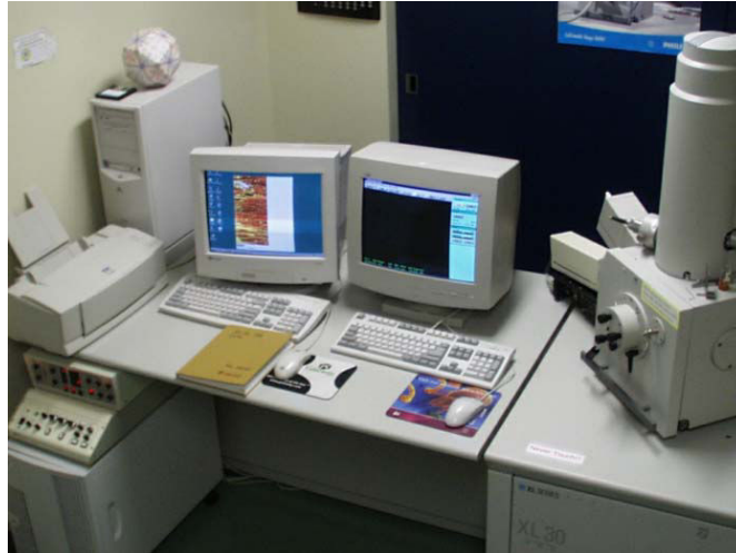
Figure III-10: Microscope Electronique à Balayage Philip XL30 SFEG.
