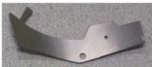
(c) - pièce à grande courbure emboutie en une passe.
