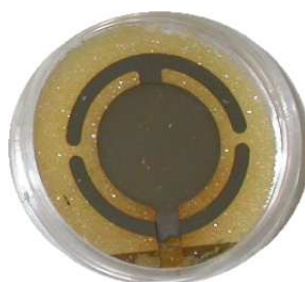
FIG. 3.40 – Photographie d'un quartz de microbalance Maxtek en or recouvert d'un film de Bi_2Te_3
