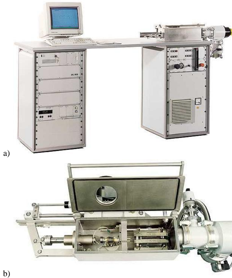
Figure II-10 : Dilato-plastomètre Bahr Thermoanalyse GmbH DIL805, a) vue d'ensemble, b) chambre de chauffage
