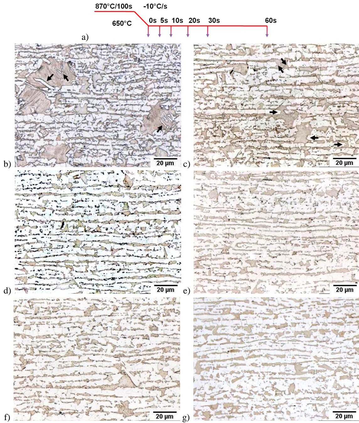
Figure IV-4 : Microstructures obtenues au cours d'un maintien isotherme à 650°C schématisé en a) suivi d'une trempe après b) 0 s ; c) 5 s ; d) 10 s ; e) 20 s ; f) 30 s et g) 60 s
