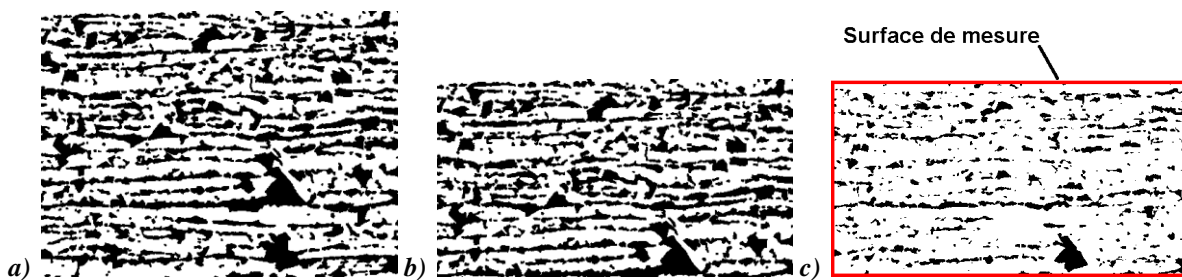
Figure III-6 : a) Image binaire d'une microstructure, b) image traduite d'un vecteur \vec{h} , c) intersection de l'image initiale et de l'image traduite
