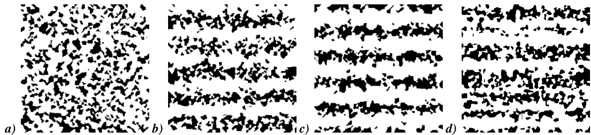
Figure III-13 : Microstructures modèles générées avec une fonction a) constante ; b) sinus ; c) « saw » ; et d) "saw" avec dispersion sur la distance inter-bande
