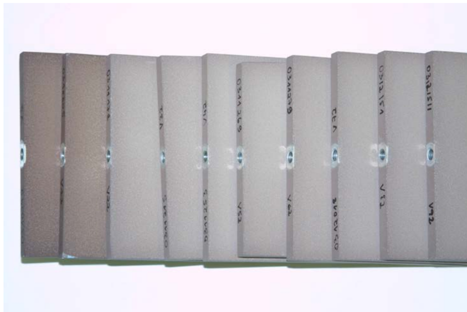
Figure V.9 : Evolution de l'aspect de surface des éprouvettes avec le vieillissement de l'électrolyte (de gauche à droite, éprouvettes n° 2, 12, 22, 32, 42, 52, 62, 72, 82 et 92).
