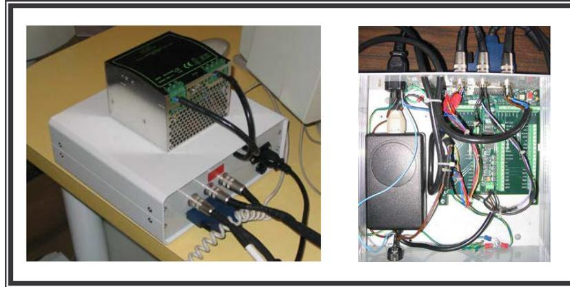
Figure III-31 : Boîtier d'alimentation de la plateforme
