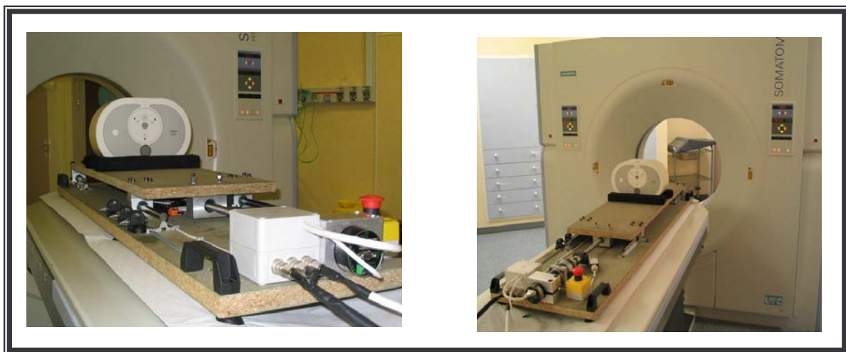
Figure IV-3: Mise en place du fantôme sur la table du scanner
