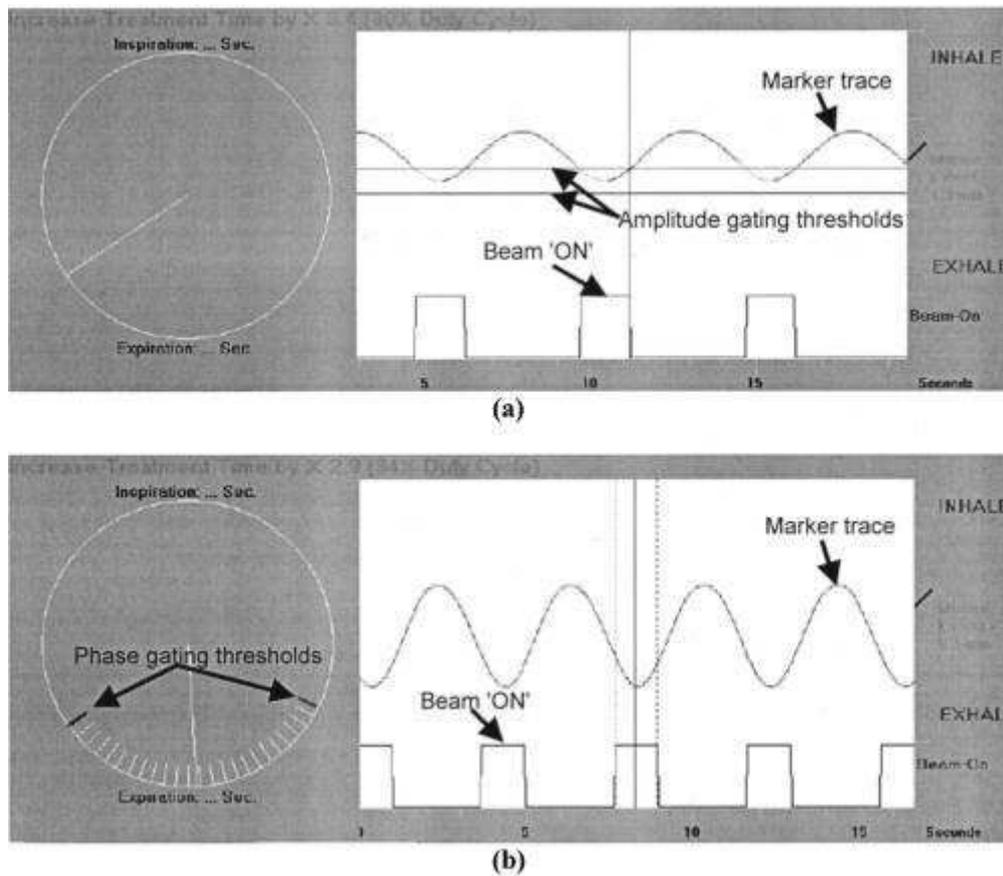
**Figure 2-4:** Asservissement d'amplitude (a) et de phase (b)
