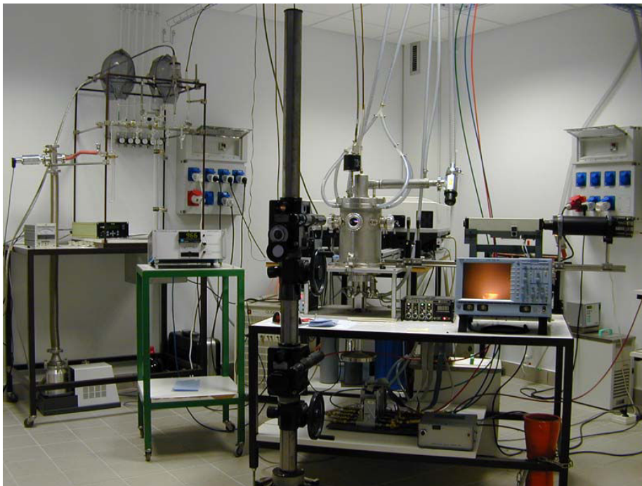
Figure II.2: Montage expérimental de la flamme laminaire prémélangée utilisé au D. C. P. R.
