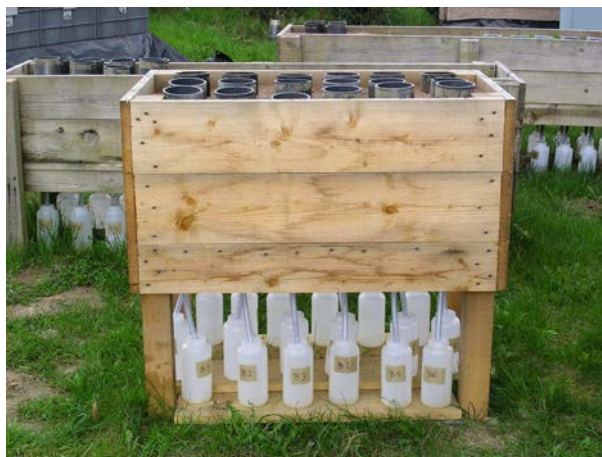
Photo 4.1 : Vue du dispositif de suivi du devenir du glyphosate dans les sols.
