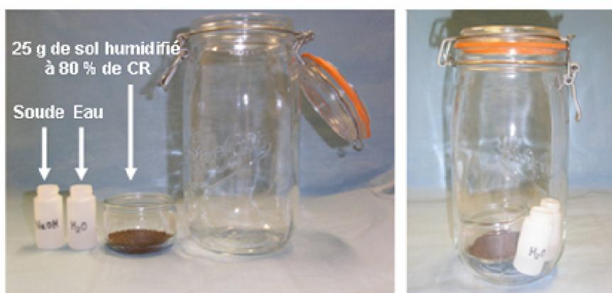
**Photo 3.1.** Dispositif des expérimentations en incubation.
