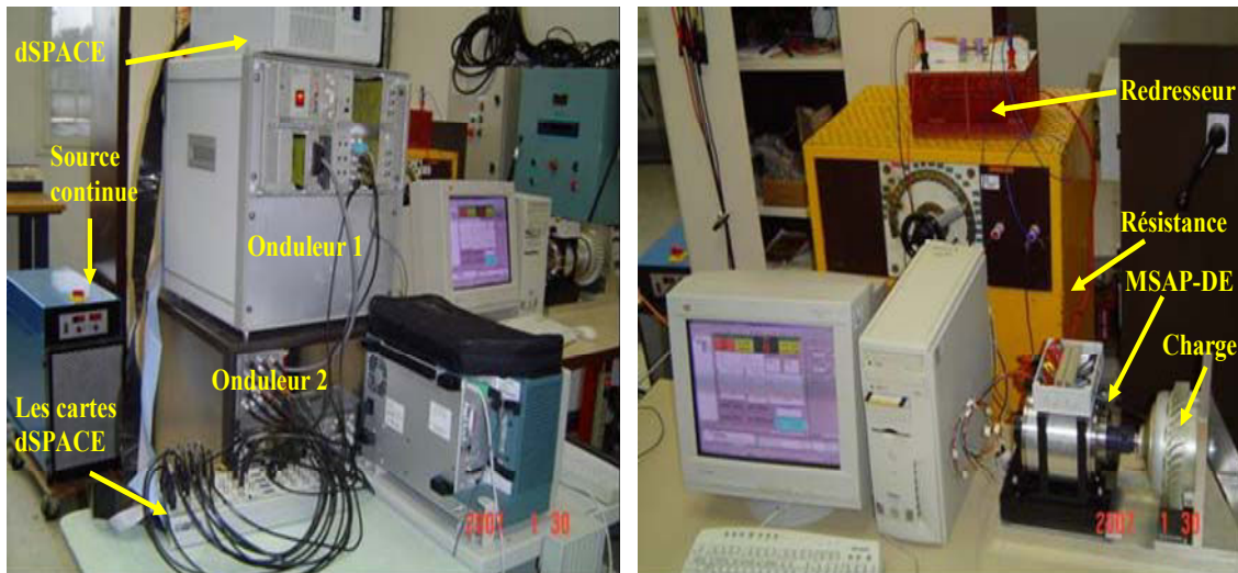
Figure 1- 39 : Le banc d'essai expérimental.
