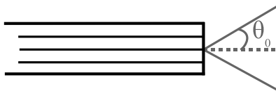
FIG. 3.3 – Angle critique d'une fibre.
