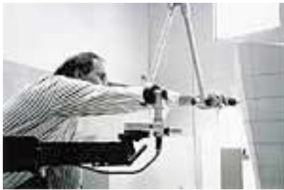
Etape N°1 : numérisation de la maquette physique. (ph.29)
