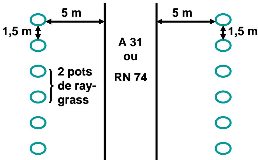
**Schéma 3** : Disposition des pots de ray-grass à proximité des voies routières A31 et RN 74
