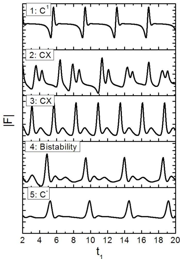
Figure 7.7: Evolution temporelle de l'amplitude du champ optique  $F$ , dans le cas de dynamiques pulsées auto-entretenues observées dans les différentes régions notées  $C^1$ ,  $CX$ ,  $C^-$ . Les labels 1 à 5 correspondent aux points indiqués dans le diagramme de bifurcation de la figure 7.6, le long des flèches  $A$  et  $A'$ .
