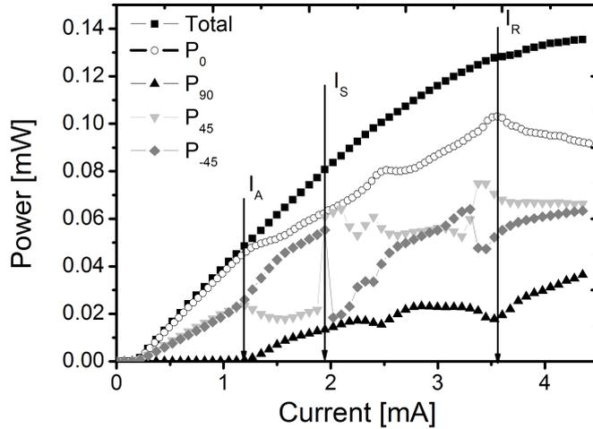
Figure 7.2: Caractéristique puissance-courant typique des lasers QD VCSELs analysés. Les notations  $P_i$  correspondent à des puissances mesurées avec une orientation de  $i$  degrés par rapport à une polarisation linéaire selon l'axe  $y$ .
