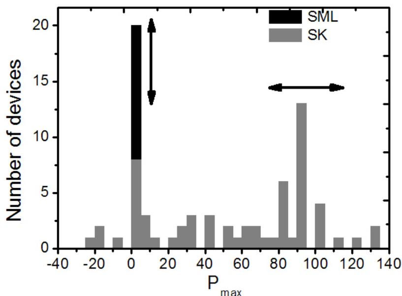
Figure 7.1: Distribution de l'orientation de polarisation ( $P_{max}$ ) pour des QD VCSELs obtenus par croissance de type SK (gris) ou SML (noir). Les orientations 0 et 90 correspondent aux axes cristallographiques principaux.
