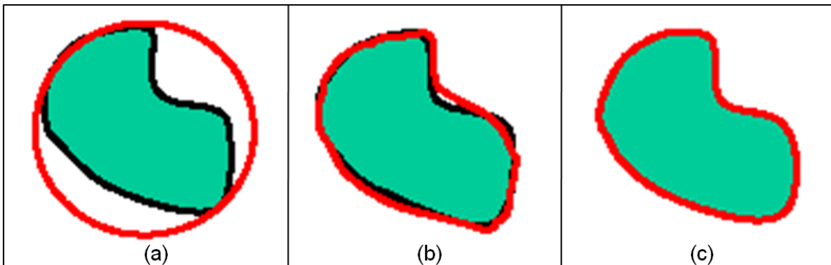
FIGURE 1.4: Modèle de contour actif ( snake ) : (a) position initiale du snake (cercle rouge), (b) snake après quelques itérations de déformation et (c) snake final [sna, 2009].
