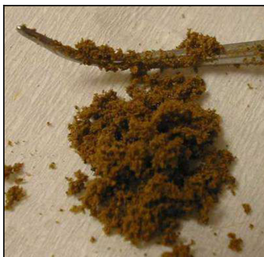
Figure I-13 : Echantillon d'algaenan isolé à partir de cultures d'algue de Botryococcus braunii Kossu.
