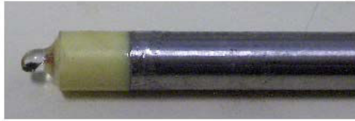
Figure 2-18 Montage individuel des thermistances.
