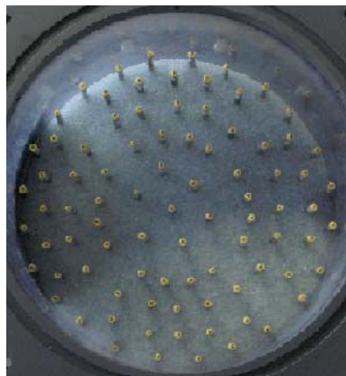
Figure 2-22 Dispositif des thermistances à l'intérieur du réacteur (vue de haut).
