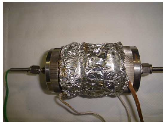
(b) colonne avec le ruban chauffant
