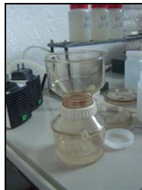
*Figure 3.10. Etapes de filtration des échantillons des eaux usées par filtre papier  $7\ \mu\text{m}$  (a) et (b) sous vide par filtre en fibre de verre  $1,2\ \mu\text{m}$  ou par membrane en acétate de cellulose  $0,45\ \mu\text{m}$ .*
