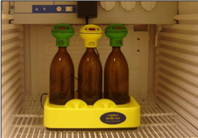
*Figure 3.12. Système OxiTop® IS 6 utilisé dans le dosage de  $DBO_5$ .*
