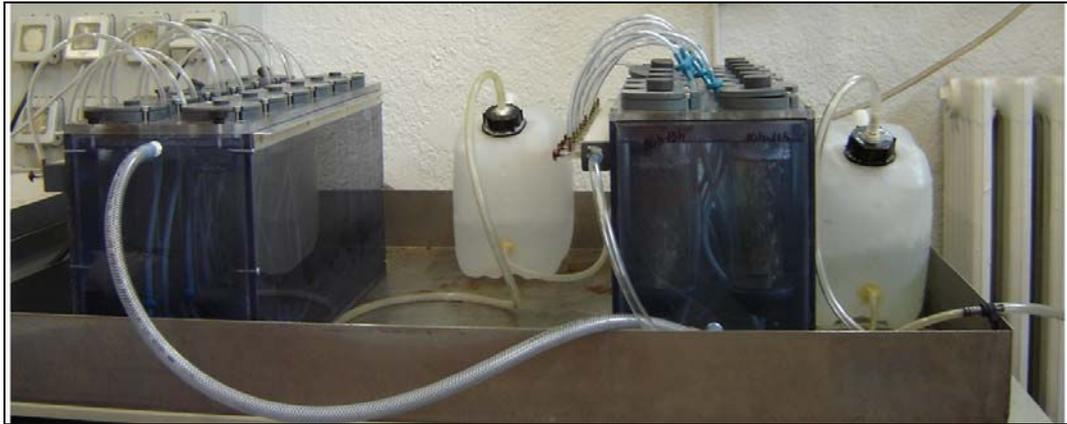
*Figure 4.3. Systèmes réactionnels utilisés dans les tests de biodégradabilité.*
