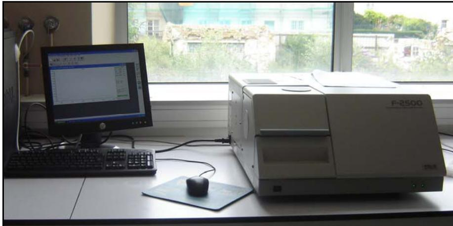
*Figure 3.17. Spectrofluorimètre utilisé pour la fluorescence synchrone.*
