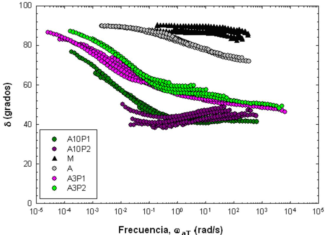
**Figura VI.20 Perfil del ángulo de fase  $\delta$  para las mezclas A3P1, A3P2, A10P1, A10P2, maltenos y asfalto.**
