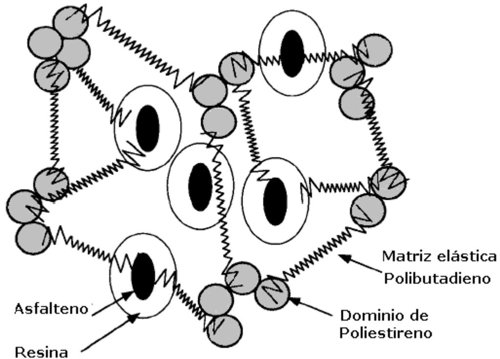
**Figura II.1. Estructura de los AM con hules termoplásticos**
