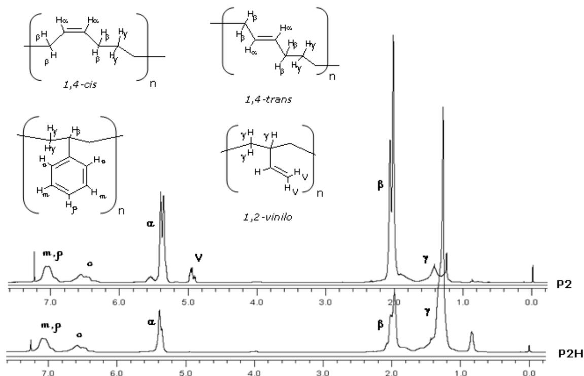
Figura IV.6. <sup>1</sup>H-RMN (300 MHz) Espectro del polímero P1 antes de la hidrogenación, después de 90 min de reacción de hidrogenación.
