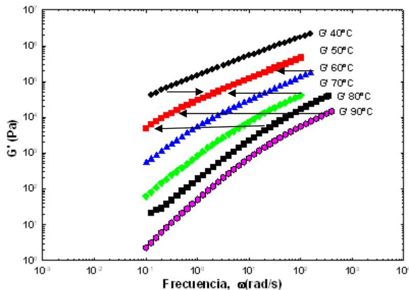
**Figura III.3. Aplicación del Principio de Superposición Tiempo-Temperatura**
