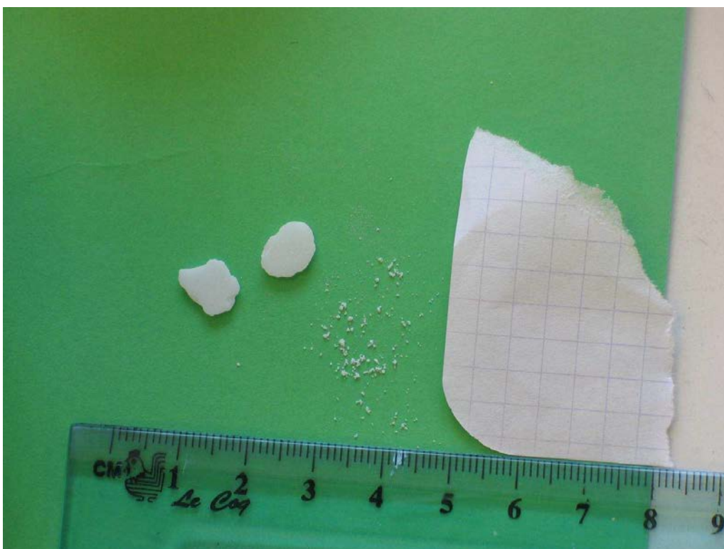
Figure 4-12 : Précipitation de la triphénylphosphine dans le réacteur d'11 : fond de réacteur
