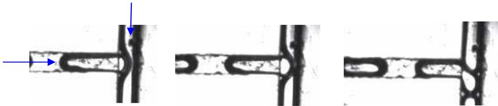
**Figure V.03.** Etude de la coalescence de bulles dans de l'eau + 3% SDS dans un micro-mélangeur en T de  $500\ \mu\text{m}$ . Les courants d'entrées sont perpendiculaires.
