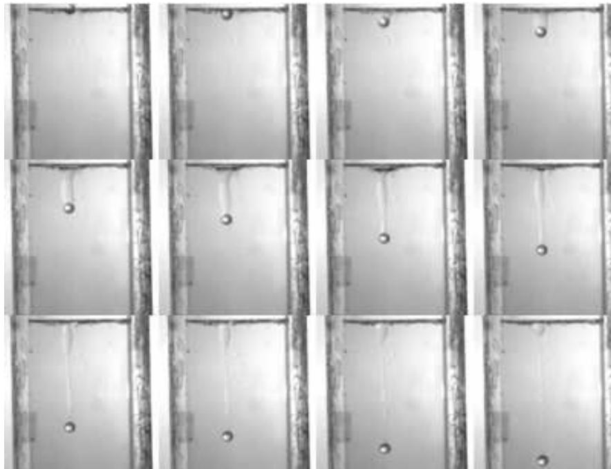
**Figure A4.7.** Franchissement de l'interface Emkarox 50% massique / huile de silicone 100 par une sphère 6 mm de diamètre en sédimentation. Images obtenues par caméra rapide numérique
