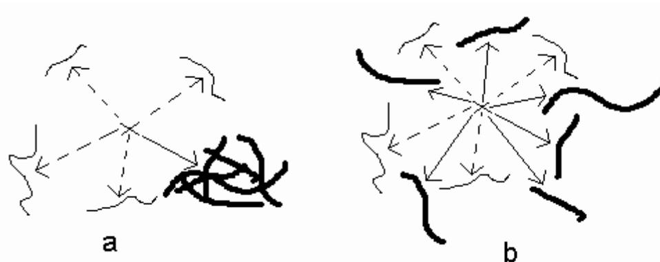
**Figure 3.12:** Effet de la dispersion des NTC sur le facteur de fréquence. La croix centrale représente un centre actif (catalyseur ou anion). Les lignes fines représentent des segments de polymère & les lignes en gras représentent des NTC. Les flèches en pointillés décrivent une collision entre un centre actif et les macromolécules. Les flèches plaines décrivent une collision entre le centre actif et les NTC (ou agrégats de NTC).
