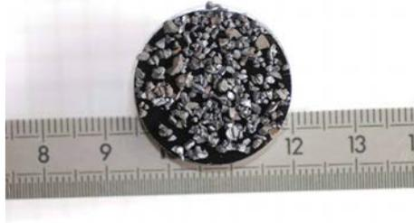
FIG. F.5 – Macrographie d'un échantillon de CuO régénéré
