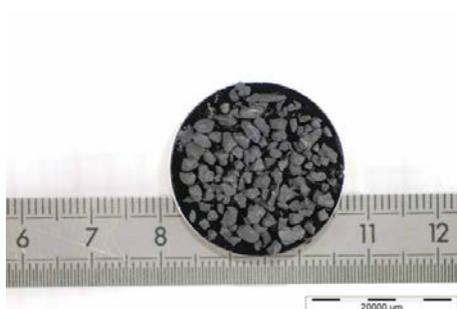
FIG. F.1 – Macrographie d'un échantillon de réactif CuO
