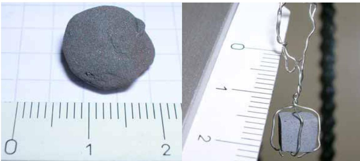
**Figure 32 : Photo d'une boulette CVRD de départ et d'un cube final.**
