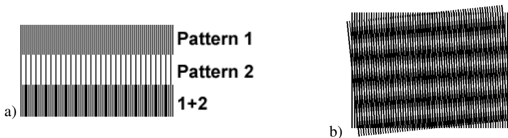
Figure 3-17 Schéma représentant les 2 types de moirés : a) moiré parallèle, b) moiré de rotation.
