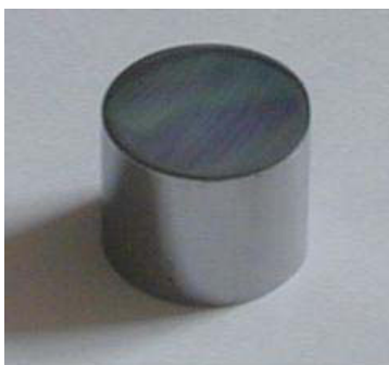
Figure 29 : Illustration d'un échantillon densifié et débarrassé de sa couche de carbone
