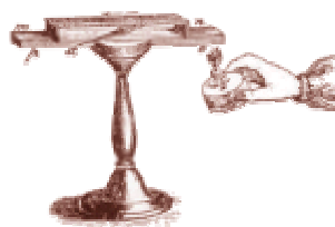
Figure 1 : Illustration de l'expérience historique de Seebeck [RIV99] : dans une boucle métallique formée de deux métaux différents soudés en série, un courant s'établit lorsque les deux soudures sont maintenues à des températures différentes. Si l'on approche une boussole de ce circuit, l'aiguille est déviée.
