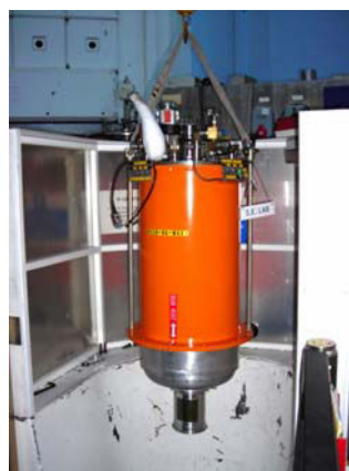
(a) (b) Figure 36 : Porte-échantillon en vanadium ( \varnothing = 6 mm) (a) et cryostat (b)
