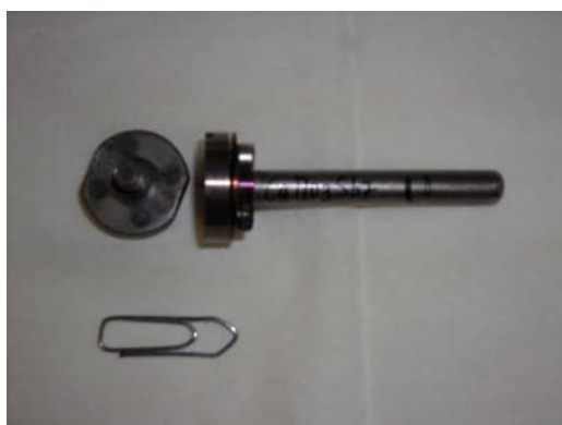
(a) (b) Figure 36 : Porte-échantillon en vanadium ( \varnothing = 6 mm) (a) et cryostat (b)
