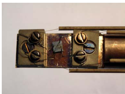
(a) (b) Figure 51 : Photographie (a) et schéma (b) de la cellule de mesure de la résistivité électrique à haute température
