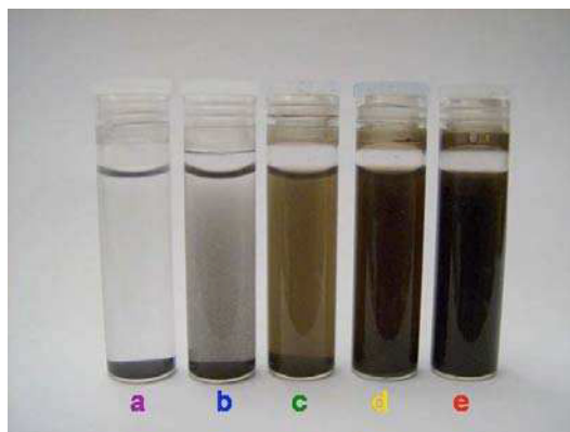
Figure III.10 Test de sédimentation. Photos prises après agitation, suivie de 30 min de repos. a) poudres initiales, b) après 9000 tirs, c) après 18000 tirs, d) après 27000 tirs, e) après 36000 tirs. ( \lambda = 532 nm, matériau de type p, 300 mJ en sortie, D = 27 cm).
