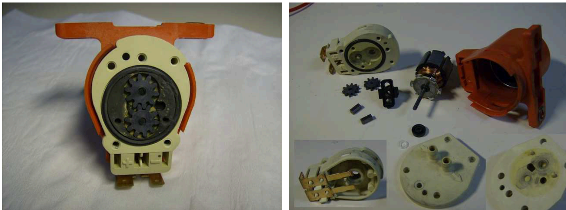
Figure II.17 Démontage de la pompe quand la nature du matériau est changée (passage du type n au type p ou vice-versa).
