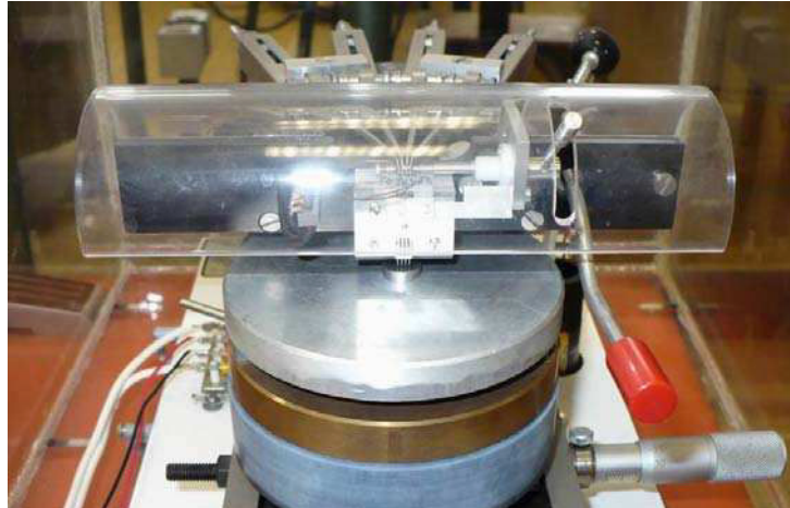
Figure IV.2 Photo de l'appareil de mesure de la résistivité électrique avec un échantillon placé sous les quatre pointes. L'échantillon est positionné sous les pointes à l'aide d'un système de vis micrométrique.
