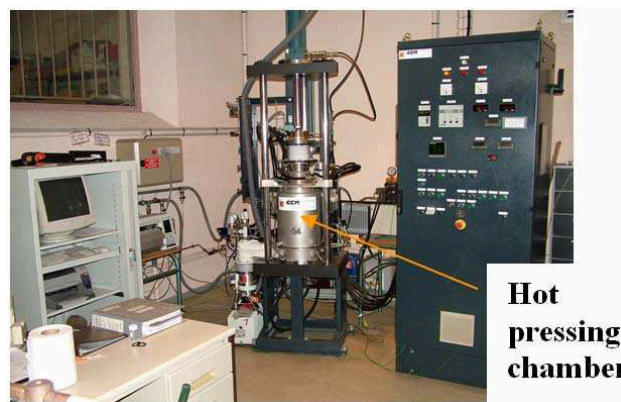
Figure II.29 Photo représentant l'ensemble du dispositif de pressage à chaud.
