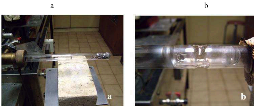
Figure II.25 a) Photo de l'ampoule sur le groupe de pompage, b) Photo du scellage du bouchon au tube principal.
