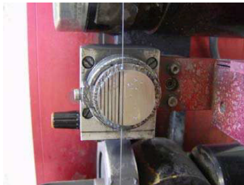
Figure IV.7 Photo montrant le dispositif de découpe pour la préparation en série de petits blocs de matériaux thermoélectriques supportant la goutte de poudres nanométriques thermoélectrique de type opposé.
