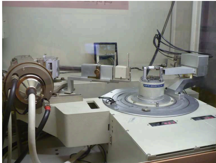
Figure III.2 Photographie du diffractomètre Siemens D500.
