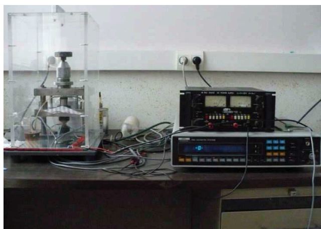
Figure IV.4 Photo de l'installation permettant la mesure du pouvoir thermoélectrique.
