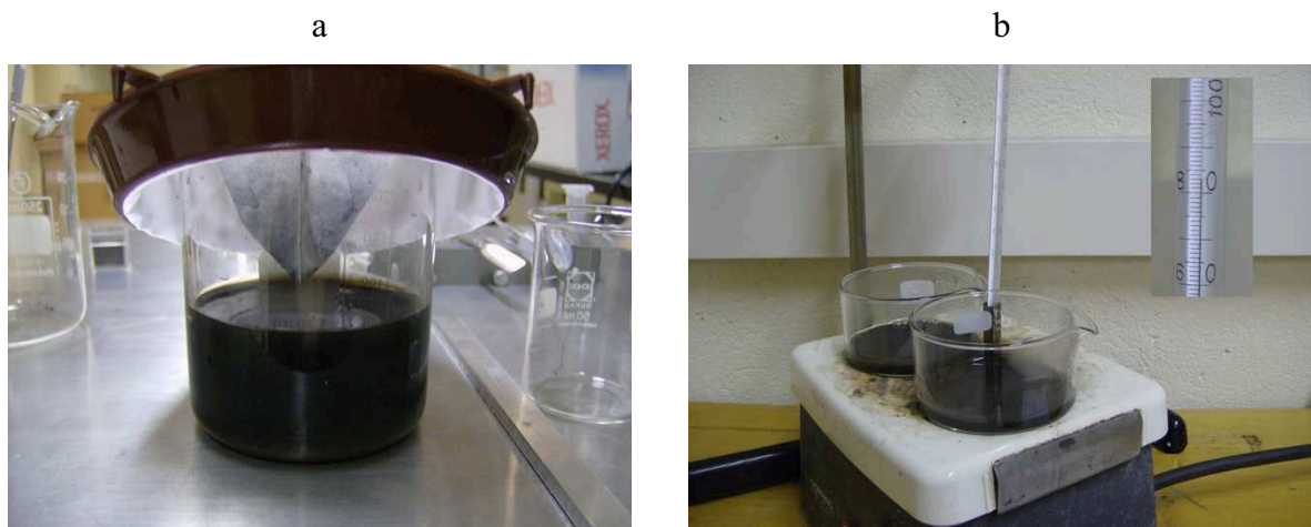
Figure II.18 Processus de récupération des poudres. a) filtration, b) séchage.
