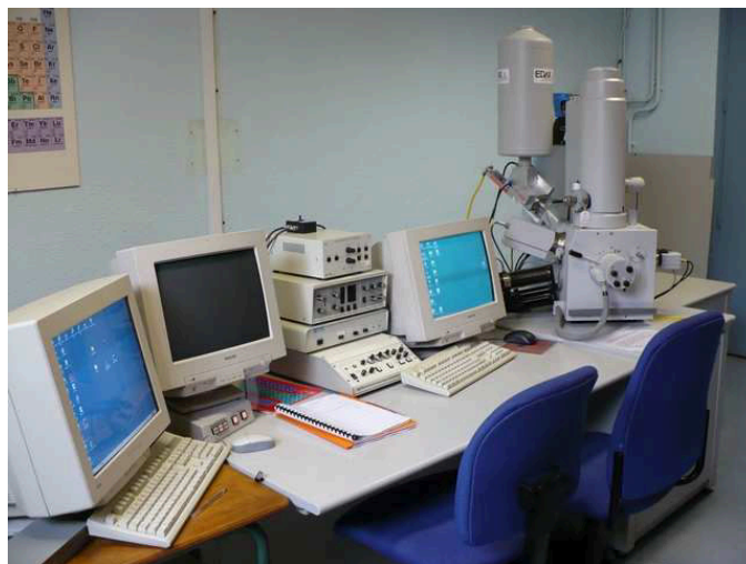
Figure III.4 Photo du microscope à balayage électronique Philips XL 30 FEG.
