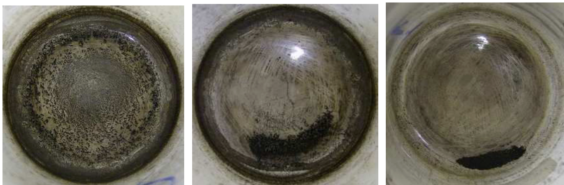
Figure II.19 Grattage des poudres après séchage
