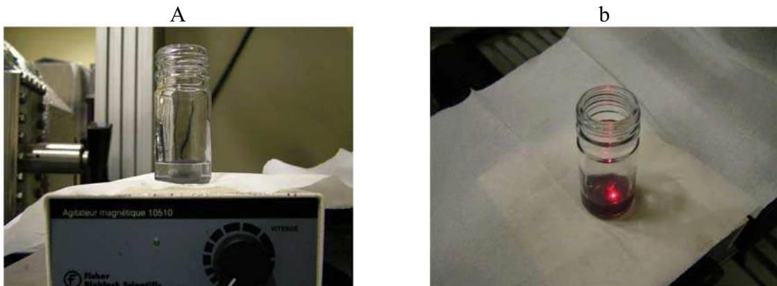
Figure II.8 Photos montrant l'expérimentation de la fracturation laser de microparticules en milieu liquide (bouteille). a) au repos, b) sous agitation (le faisceau rouge observé est celui de la diode laser).
