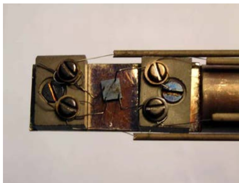
Figure IV-8 : Schéma de la cellule de mesure de la résistivité électrique à haute température.
