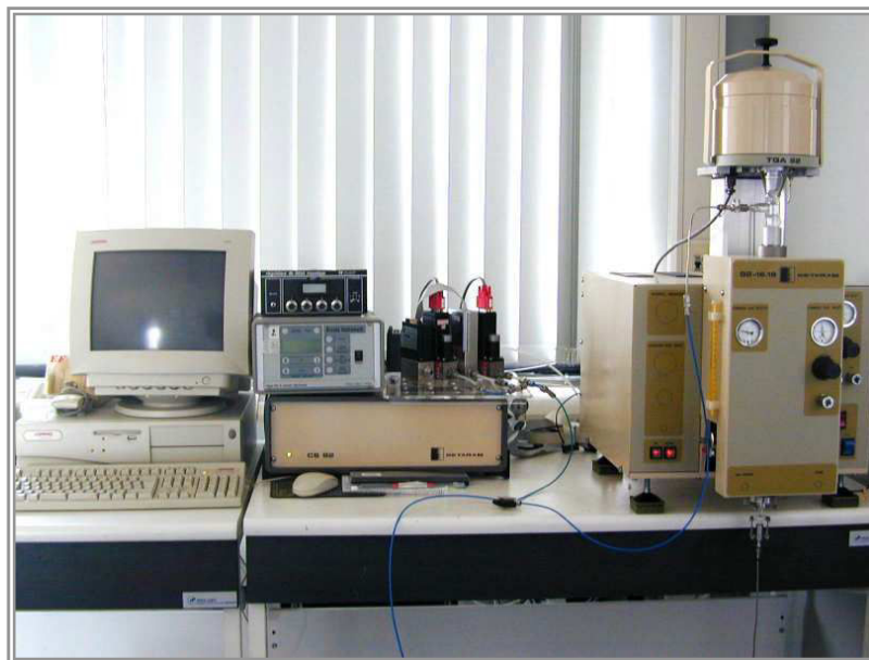
Figure II. 4. Système de nitruration.
